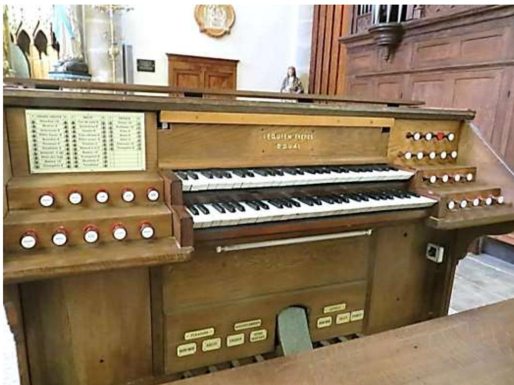
Transmission : La transmission permet de communiquer le mouvement entre la touche du clavier et la soupape du sommier. Elle comporte une série de contacts électriques qui mettent en mouvement les électroaimants qui actionnent des soupapes.
